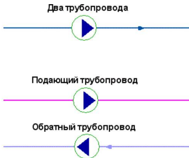
Рис. 27. Сверху: однолинейное изображение сети, снизу- внутреннее представление.
