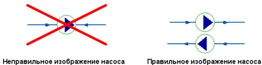
Рис. 28. Неправильное и правильное изображение насоса
